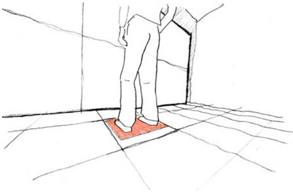
Bild 4 Gewichtsmessung im Boden integriert
