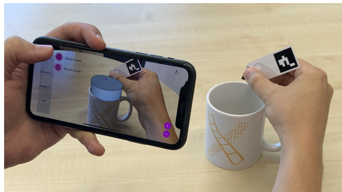
Abb. 7: Der ARPen im Einsatz mit dem auf Karton gedruckten Stift. Zeichenfunktionen wählt man auf dem Smartphone-Touchscreen aus. Diese Variante erlaubt das 3D-Modellieren in AR überall mit dem eigenen Smartphone und einem Stift, der in jedes Portemonnaie passt. Download der iOS-App genügt; der Stift ist in der App als PDF zum Ausdrucken verfügbar.
